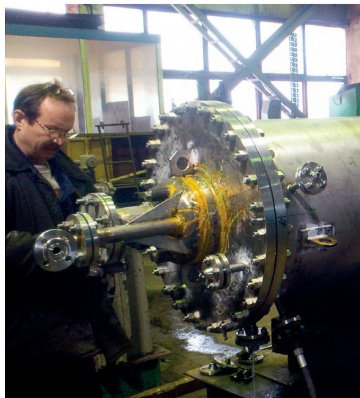
Изготовление реактора синтеза селеноводорода для ООО «Оптика-НН» по нашей рабочей документации
